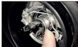
**1-** Desligue o motor. Aguarde até ele esfriar. Abra o capô do carro e remova a tampa protetora contra poeira. Solte o parafuso fixo e retire a lâmpada original do farol.
