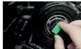
**5-** Desligue o motor, aguarde até que ele esfrie. Abra o capô do carro, remova a tampa protetora contra poeira e retire a lâmpada do farol original.
