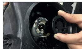
**6-** Pegue a Lâmpada **LED K2 MINI** insira no farol do carro, aperte-o no sentido horário. Conecte o cabo de alimentação, ligue o para garantir que funcione bem. Instalação concluída!
